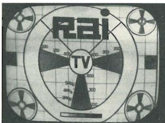
Fig. 1.29. - Esempio di linearità verticale difettosa.
