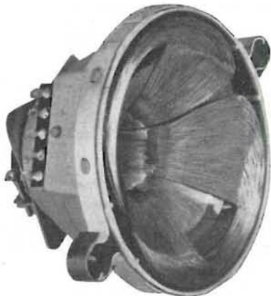
Fig. 7.3. - Giogo di deflessione tolto dal cinescopio. Sono visibili gli avvolgimenti delle bobine di deflessione.
